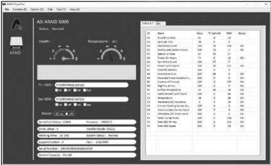
圖 1. 利用 ARAID EYE PLUS 軟體檢測硬碟品質
